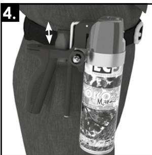
Gegen unbeabsichtigtes Sprühen den **GÜRTELCLIP** an der Hose oder dem Gürtel befestigen und den Sprühgriff hinter dem Hebel aufstecken. Nun ist der Sprühgriff gegen unbeabsichtigtes Auslösen gesichert.
