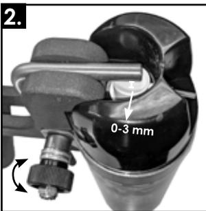
**PROFISPRÜHGRIFF** über die Ergokappe führen, bis dieser fest aufliegt und Feststellschraube zudrehen. Der Sprühgriff sitzt ideal, wenn der Zughebel 0-3 mm über dem Sprühkopf liegt. Durch das Lösen der Feststellschraube kann der Griff bequem ausgerichtet und individuell in der Höhe angepasst werden.
